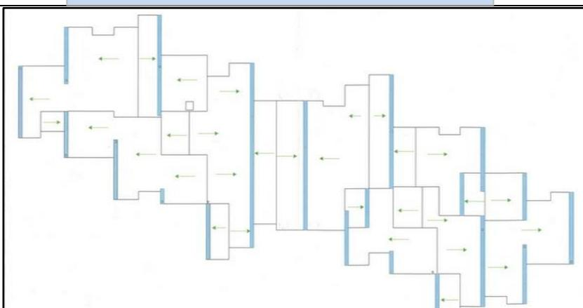
Plan de repérage des toitures et bardages à déposer sur l'un des deux bâtiments traités (Bâtiments identiques).
